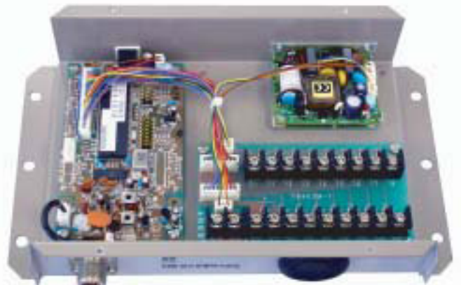
▲ N (微弱) 型 16点型送信機内部配置例
